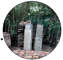
Utilisation des seuils extérieurs de la façade arrière comme parement de sol de la terrasse
